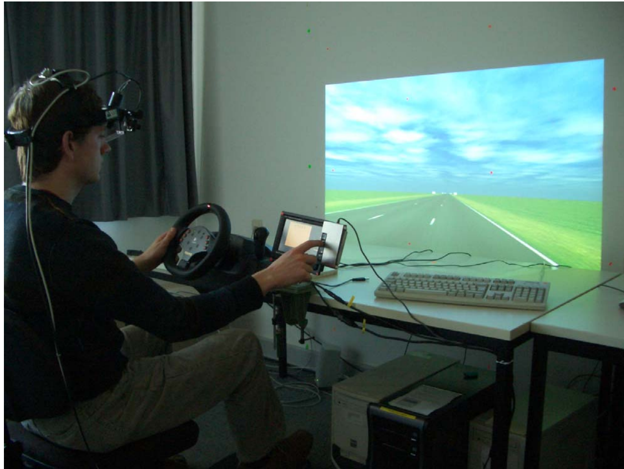
Versuchsaufbau mit Lane Change Task, D2-Drive und Blickbewegungskamera.
